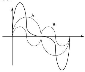
若放大器對  $A \cdot B$  弦波的振幅做不同程度的放大時,如下圖所示,波形 A 位放大,波形 B 放大 2 倍,輸出波形和上圖比較,則已明顯失真,這種放大器對不同頻率輸入信號以不同倍數放大產生的失真,稱爲"頻率失真"一個理想的放大器在工作頻率範圍內,應該對不同頻率的信號,有相同的放大倍數,否則就會產生頻率失真。
