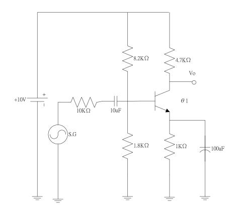
1. 依照上圖所示,將電路接妥。將信號產生器頻率設定爲 10kHz,調整振幅使放大器輸出波形不失真,此時的 Vi=\_\_\_\_\_V,Vo=\_\_\_\_V(峰值),Av=\_\_\_。
